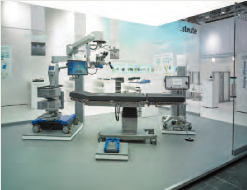
Bild 2: Demonstrator für ein Bediensystem im interoperablen OP. Der Operateur legt per Touchscreen oder Sprachsteuerung fest, welches Medizingerät über das User Interface bedient wird (Bildnachweis: steute Technologies GmbH & Co. KG)
